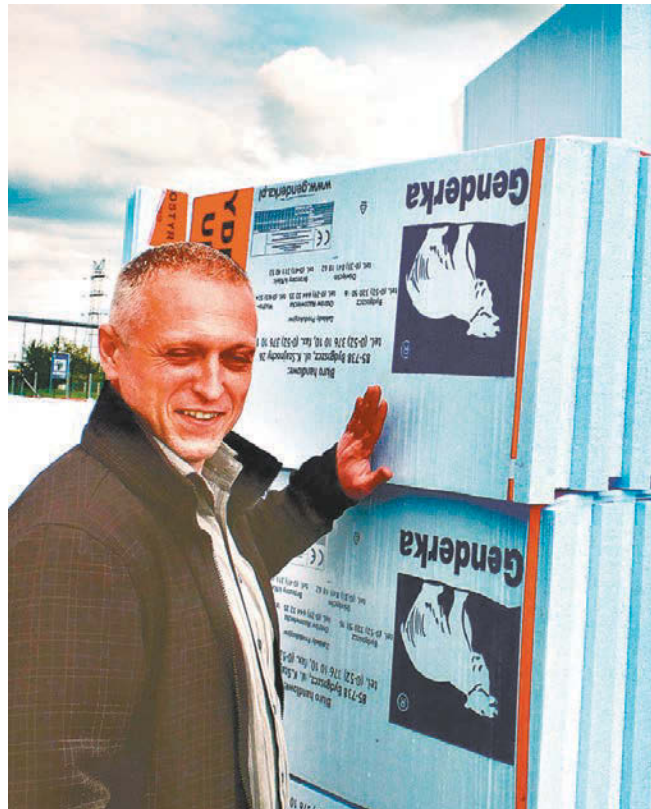
Artur Folega z opolskiej hurtowni materiałów budowlanych pokazuje aquastyropian wykorzystywany do izolacji fundamentów.
